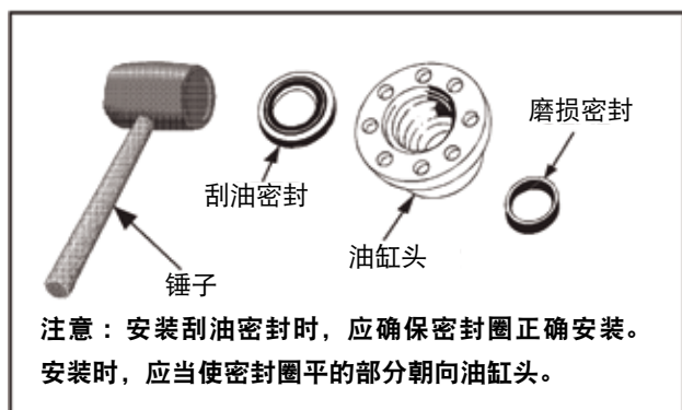
图 5-7. 刮油密封安装
